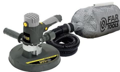
La ponceuse orbitale possède un moteur de 1 200 W à variateur de vitesse électronique (1400 à 3100 tr/min) pour une puissance de travail constante. Le ponçage des plaques se fait par des disques abrasifs autoagrippants.
