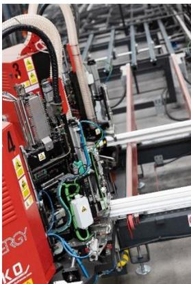
Nouvel équipement permettant de réaliser un assemblage de qualité par soudure bord à bord pour les fenêtres en finition plaxée et spectral.
