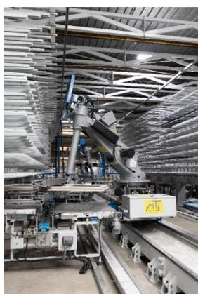
2 robots 7 axes gèrent simultanément et en autonomie le stockage et la manutention des ouvrants en cours de production, leurs orientations sur les différentes lignes d'assemblage et les changements de faces nécessaires aux différentes opérations d'assemblage.
