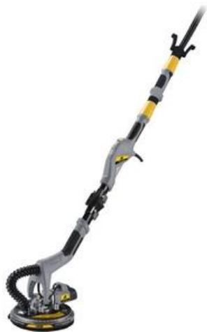
Dotée d'un moteur de 810 W (puissance plus élevée que la moyenne du marché), la ponceuse **ENERGY SAND-225** intègre des équipements qui facilitent le travail : une lumière rasante par éclairage LED pour un repérage rapide des aspérités ; et un carter escamotable optimisant le ponçage des angles et bordures. Le ponçage du plâtre se fait par des disques abrasifs auto-agrippants 8 trous de 225 mm de diamètre.
