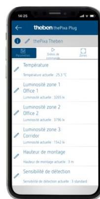
Les fonctions du thePixa sont pilotées à partir de l'**application thePixa Plug** (sur iOS et Android). L'application permet également la comparaison des mesures de luminosité et de température, et la création de **cartes thermiques** (heat map) pour le comptage statistique. Elle utilise le protocole de communication Bluetooth Low Energy (BLE) à très faible consommation d'énergie.
